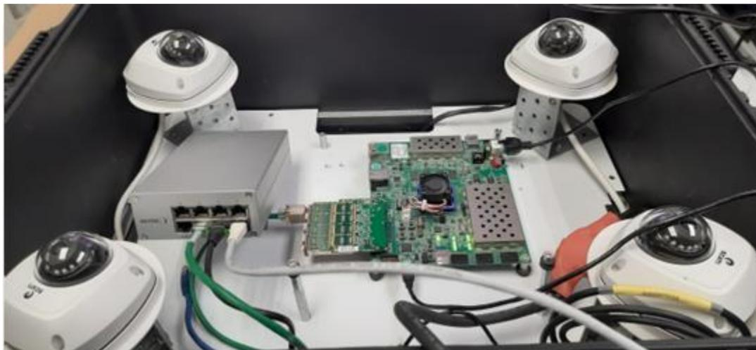
Figure 144. Integración en el diseño de una tarjeta de ampliación FMC.
